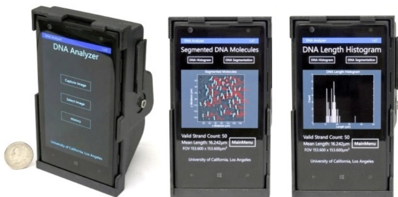
Urządzenie obrazujące i interfejs użytkownika. Zdjęcie: Ozcan Group, UCLA
